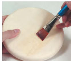
③手早く塗り、15～30分ほど乾かします。軽くサンディング(細目)し、表面を整え、タッククロスで表面を拭きます。
