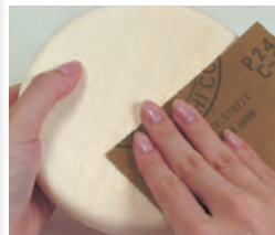
①木目に沿ってサンディング(粗目)し、タッククロスで木くずを拭き取ります。
