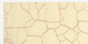
大きいクラックル：II液を厚めに塗る。
